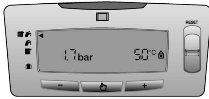
Figuur 7. Weergave display bij toepassing van een buitenvoeler
