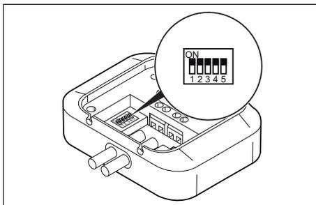
Les 5 leviers des contacts numérotés de 1 à 5 sont situés à l'arrière du récepteur radio.
