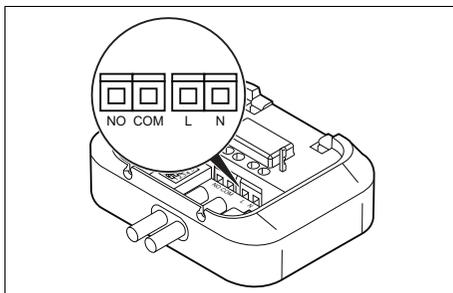
1. Retirez et passez les câbles dans les passes-fils sécables du récepteur radio.
