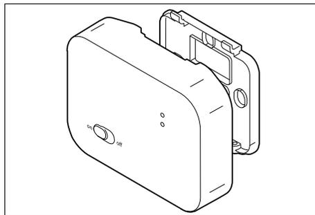
1. Positionnez le récepteur radio sur la plaque de fixation.
